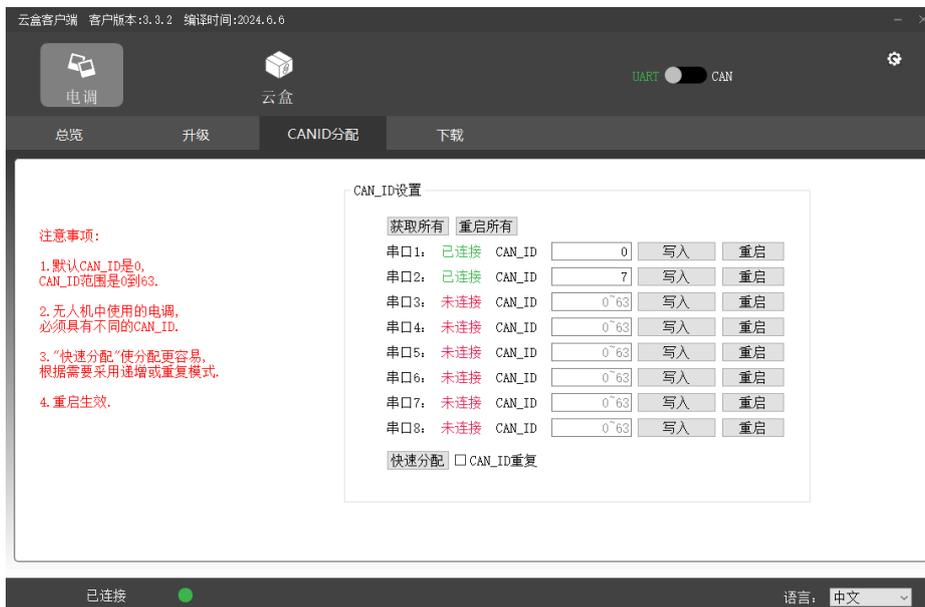
批量写入支持以下两种规则：勾选“CAN\_ID 重复”选项，所有电调 CAN\_ID 均相同，点击“批量写入”出现弹窗，可输入指定的 CAN\_ID；不勾选“CAN\_ID 重复”选项，所有电调 CAN\_ID 均不相同且 CAN\_ID 自增，点击“批量写入”出现弹窗，可输入起始的 CAN\_ID。
