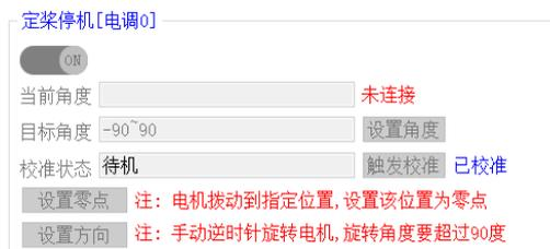
当电调连接的电机有霍尔传感器时，可以选择打开定桨停机功能，电机能够在目标角度停止。如果没有连接，此功能会被禁用。
